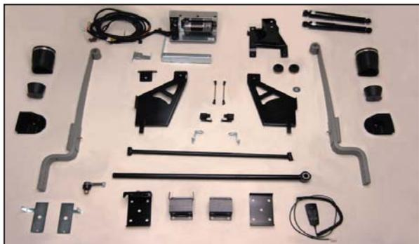
Pour le Jumper de Citroën une suspension pneumatique pour l'essieu arrière est disponible. Le Jumper est extrêmement qualifié pour l'utilisation d'une suspension pneumatique. Le VB-FullAir 2C peut être monté sur des véhicules neufs comme des véhicules occasion.
