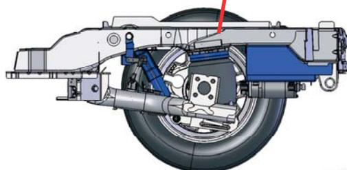
*avec VB-FullAir 2-Corner suspension pneumatique*
