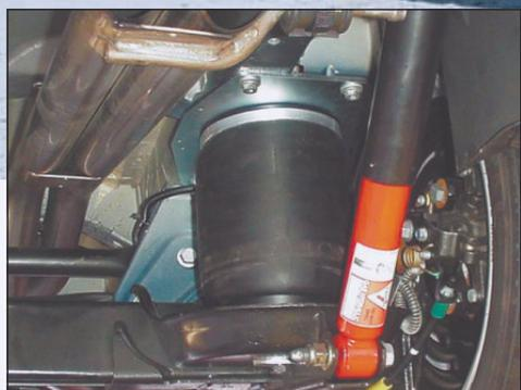
*avec VB-FullAir suspension pneumatique pour l'essieu arrière*
